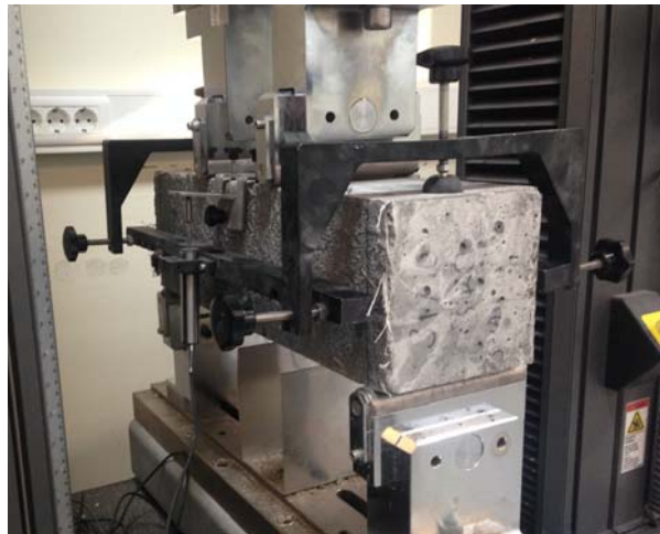
ASTM C 1609 test düzeneği
