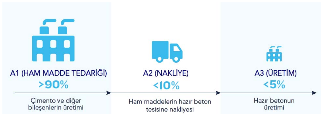
Şekil 1 - Hazır betonun beşikten kapıya emisyon aşamaları [11]
