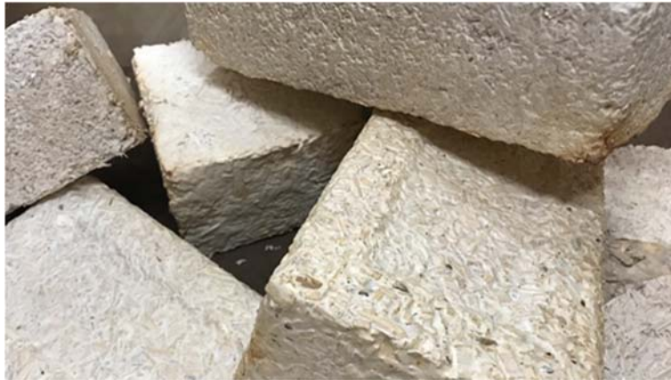
Şekil 8 - Sertleşmiş yüzeyli Miselyum tuğlaları.
