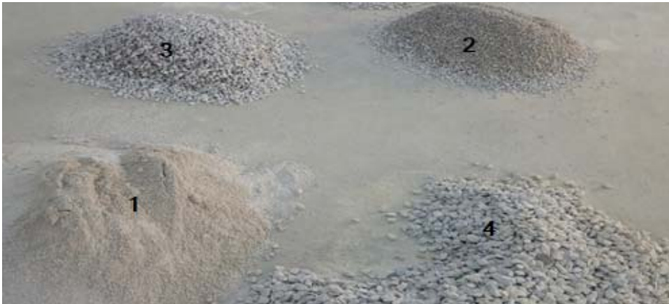
Şekil 2 - (1) 0-5 mm Kum, (2) 5-12 mm İnce Agrega, (3) 12-19 mm Kaba Agrega ve (4) 19-25 mm Kaba Agrega Görseli.
