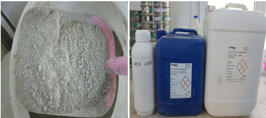
Şekil 3 - (a) Curuf Görseli, (b) Süperakışkanlaştırıcı Görseli.
