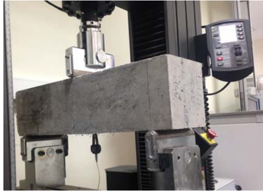
EN 14651 test düzeneği
