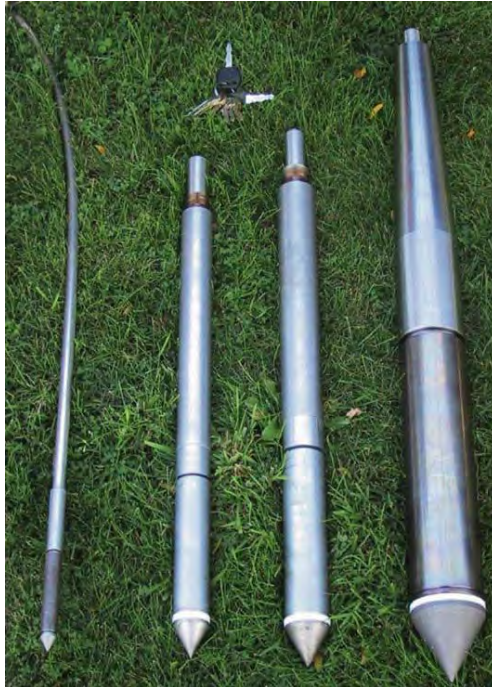
Şekil 2.6. 2, 10, 15 ve 40 cm 2 izdüşüm alanına sahip konik sondalar (Robertson ve Cabal, 2010)
