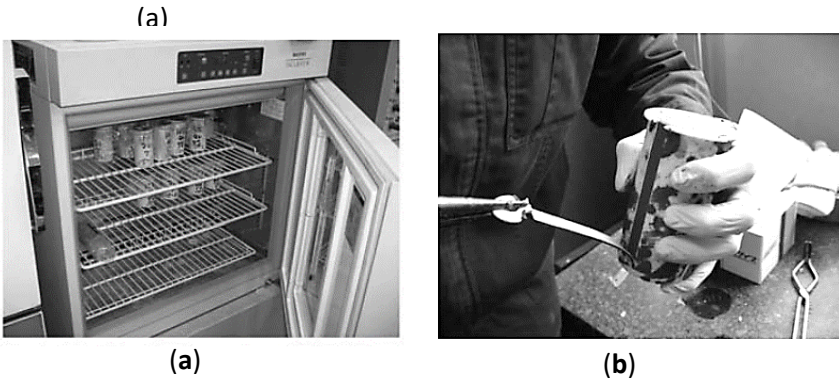
Şekil 5.4. Nem ve ısı kontrollü konteyner (a); ve boyuna yarık kalıptan örnekleme (b)
