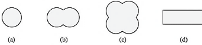
Şekil 4.5. Tipik kolon uygulamaları, (a) dairesel, (b) ikili, (c) dörtlü ve (d) panel
