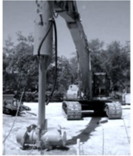
Şekil 1.15. Özel karıştırıcı uçlar (Kitazume ve Terashi, 2013), (Garbin ve Mann, 2010)
